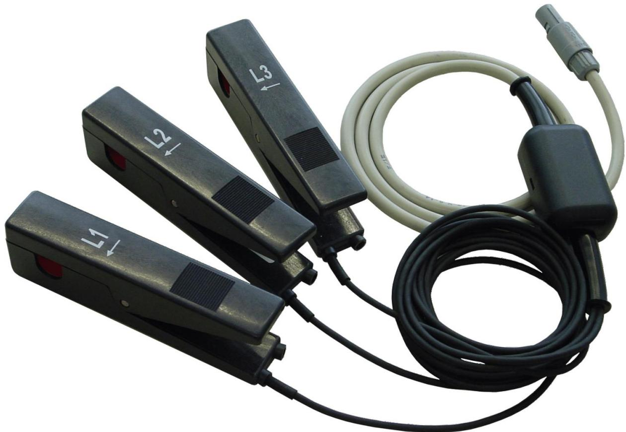
Die elektronisch kompensierten Stromzangen wurden für Strommessungen im Bereich von 10 mA bis 100 A entwickelt. Die kleinen Abmessungen erlauben auch Arbeiten in beengten Räumen, wie zum Beispiel in Zähler- oder Sicherungsautomateninstallationen.
